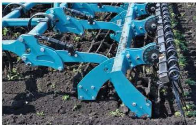
Тандемный каток с пружинной бороной
