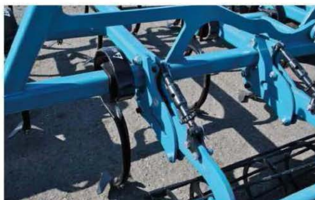
Мощная рама, высокая стойка, лапа шириной 200 мм.
