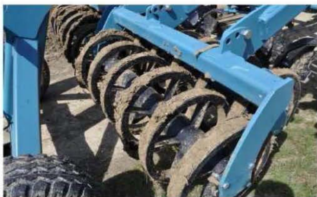
Самоочищающийся тяжелый тандемный каток
