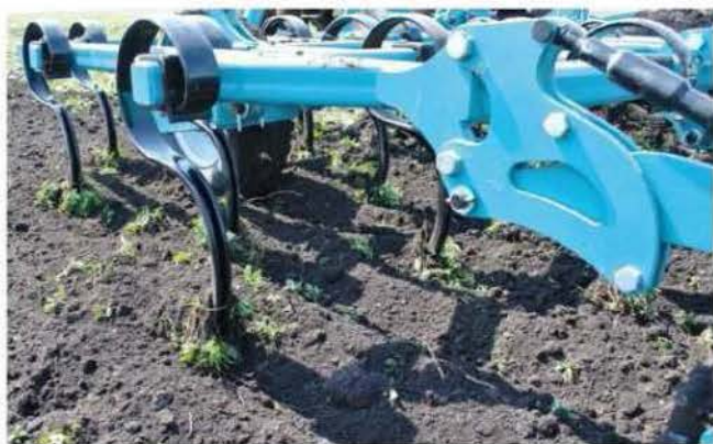
Пружинные стойки (высотой 60 см.) расположены в 5 рядов, что препятствует забиванию
