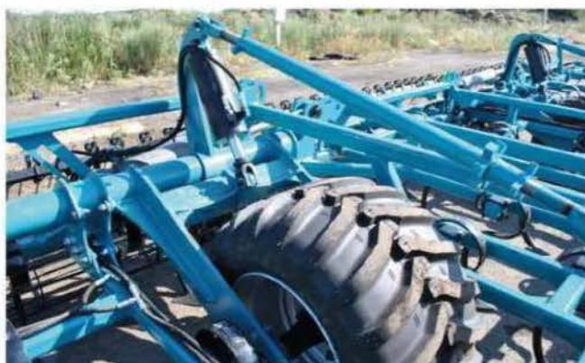
Система стабилизации, большие транспортные колеса
