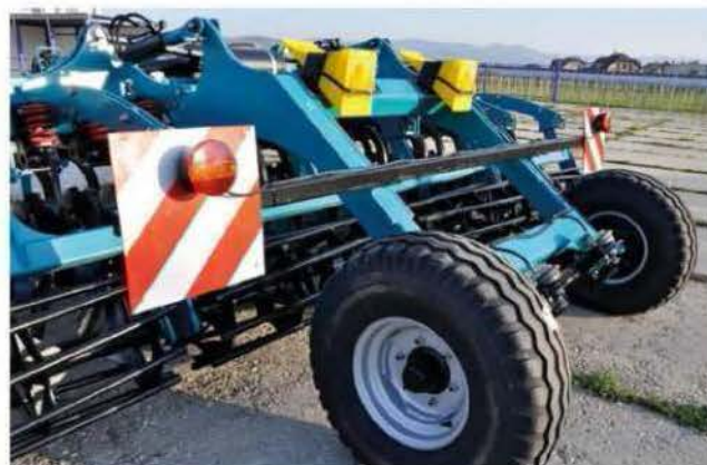
Ходовая тележка со световыми приборами и тормозной системой
