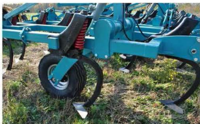
Пружинный блок защиты стойки
