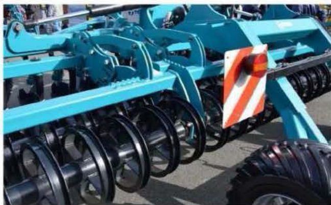
Компактное расположение тяжелых тандемных катков
