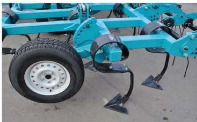
Мощная складная рама с опорными колесами
