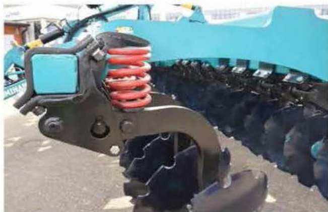
Пружинный защитный блок
