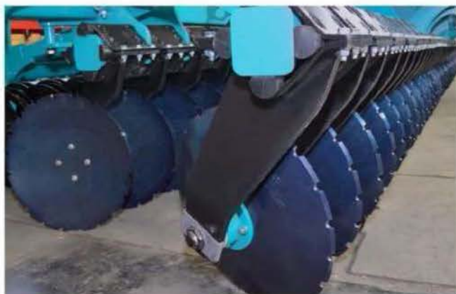
Увеличенная высота стойки режущего узла
