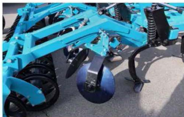
Модуль выравнивания с дисками и тяжелым катком
