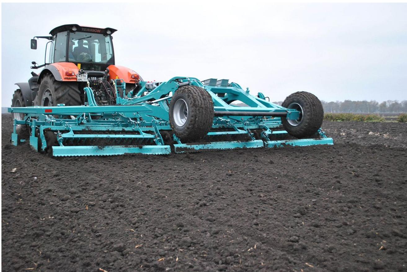
Культиватор «Контур» предназначен для подготовки почвы под посев с возможностью разной комплектации и установки оборудования. Культиватор обеспечивает повышенное качество культивации и выравнивание почвы перед посевом культур, требовательных к соблюдению постоянной глубины посева с образованием ровного посевного ложа (сахарная свекла, рапс и др.), вследствие чего получение «дружных» всходов и повышенной урожайности культур.
